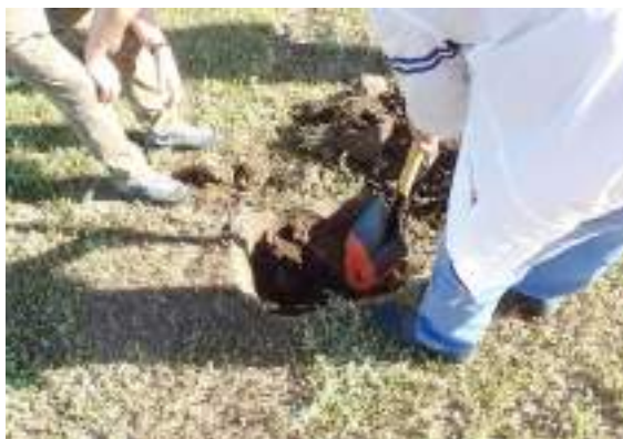
Зураг 2: Хөрсний дээж авах байдал
